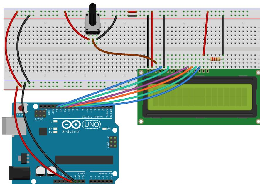
Potenciometar u spoju na slici služi za reguliranje kontrasta LCD ekrana, dok otpornik služi za ograničavanje struje LED diode za pozadinsko osvjetljenje.
