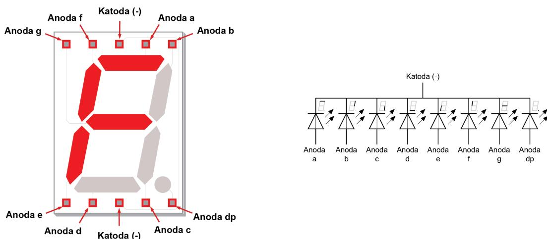
Postoje dvije vrste ekrania, oni sa zajedničkom katodom i oni sa zajedničkom anodom. U ovoj ćemo pripremi raditi sa sedam segmentnim ekranima sa zajedničkom katodom. Na sljedećoj slici pogledajte način spajanja ekrania sa zajedničkom katodom na mikrokontroler.
