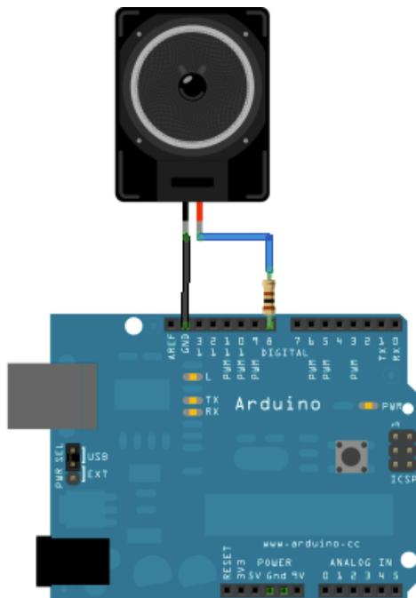
Ukoliko spajate zvučnik on mora imati 8 ohma a predotpornik koji je vidljiv na slici neka bude 100-120 ohma. Ukoliko na Arduino spajate piezo zujalicu predotpornik nije potreban.
